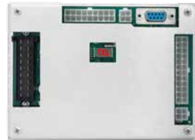
Hauptmodul im Dach-HLK-Gerät (145 x 104 x 31 mm)
